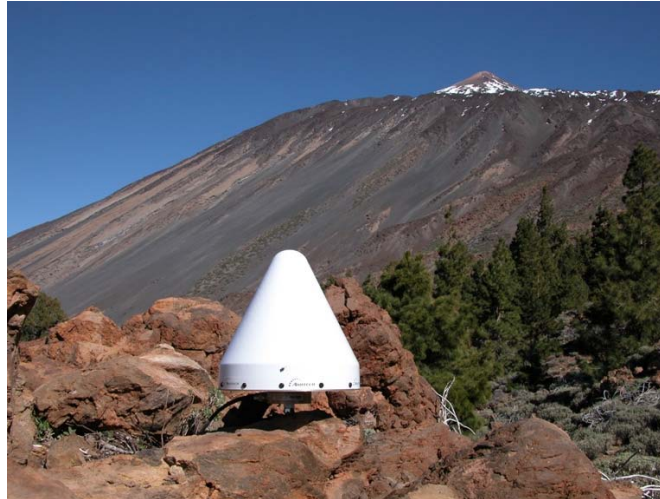
Fig. 12. Antena GPS en la cara norte del Pico Viejo que conforma la red geodésica instrumental permanente del ITER para la vigilancia volcánica en Canarias.
