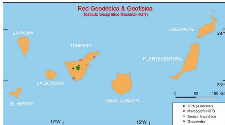
Fig. 13. Red geodésica y geofísica del Instituto Geográfico Nacional (IGN) para la vigilancia sísmica y volcánica en Canarias.
