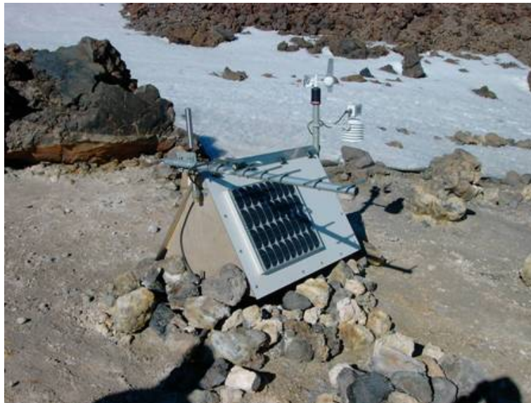
Fig. 5. Estación geoquímica TFE01 para medida de flujo de gases localizada en el Pico del Teide y operativa desde abril de 1999.
