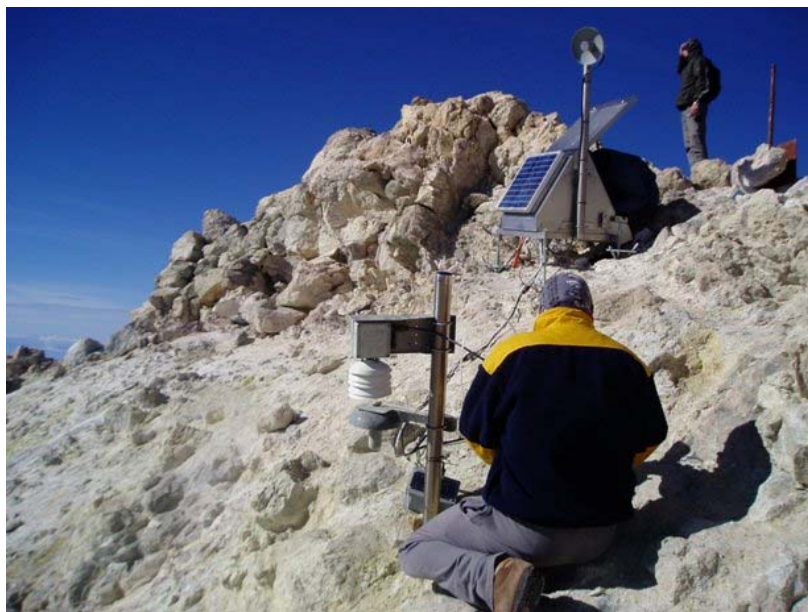
Fig. 7. Estación geoquímica para el seguimiento y medida de ratios de los principales componentes de los gases volcánicos emitidos por la actividad fumarolita del Pico del Teide
